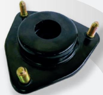
Las bases de amortiguador realizan el mismo trabajo que los soportes de motor. Mantener el vástago del amortiguador centrado resistiendo el impacto de las vibraciones y la presión generada por la carrera que recorre en su fase de trabajo, con una peculiaridad que en su centro se encuentra un rodamiento que les permite proporcionar movimiento de giro al vástago del amortiguador conforme realiza su carrera.
