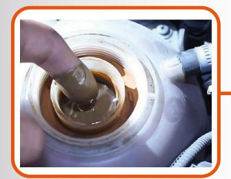
La mezcla de agua y aceite en el sistema de enfriamiento es causado por un descuido de sobrecalentamiento, ocasionando que la temperatura se incremente demasiado, la culata sufrirá alguna torcedura provocando una falla en el empaque, esto permitirá pasar agua o aceite al sistema de enfriamiento los cuales se apreciarán como una sustancia lodosa en el interior del depósito o radiador.
