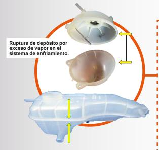
El aire que no es expulsado de forma adecuada del sistema de enfriamiento (purgado) ocasiona múltiples problemas, entre los más comunes es: la aparición de fisuras o la separación del segmento donde se une el plástico del tanque recuperador.
